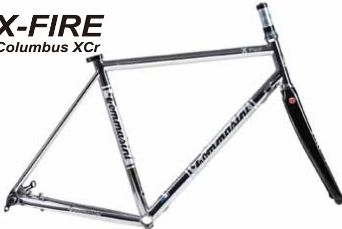
一般的に重量が重いステンレスのチューブですがこのCOLUMBUS製のステンレスXCrは肉薄でとても軽量です。この溶接の難しい肉薄のステンレスチューブを市販車としてラインナップできることが、トマジエニの高い技術力を証明しています。またステンレスの妖しい輝きは周囲のカーボンカラーやソリッドなペイントのバイクを圧倒する存在感です。
